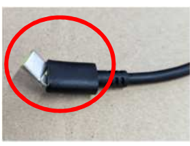
せつぞくぶぶん 接続部分がおれている
