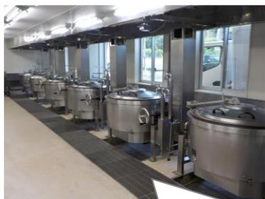
\*大きな釜が全部で6台あります。だしをとる釜、揚げ物をする釜、など、作業に合わせて使い分けます。
