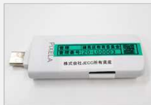
・ LTE Dongle※ 無線でネット接続するための機器
