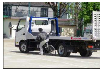
内輪差による自転車事故 (車が左に車折するときには注意)
